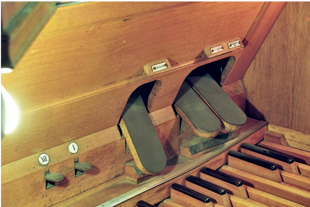
Abb. 249: Territet VD, anglikanische Kirche (Opus 301, 1906/1907), die besondere Anlage der Balanciertritte am dreimanualigen Spieltisch ( Bernhard Hörler).
