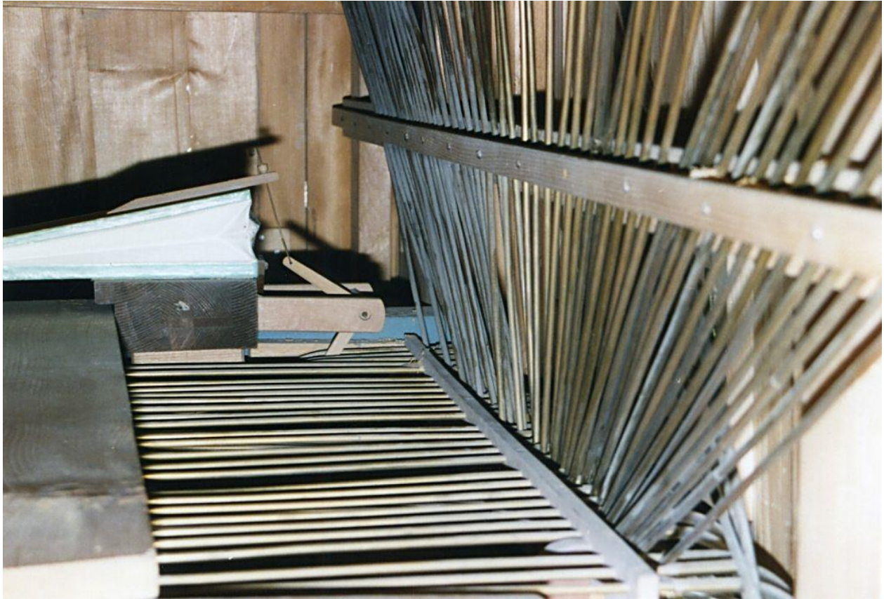
Abb. 155: Flüeli LU (Opus 179, 1898), die strahlenförmig angelegte Spieltraktur (Bernhard Hörler).
