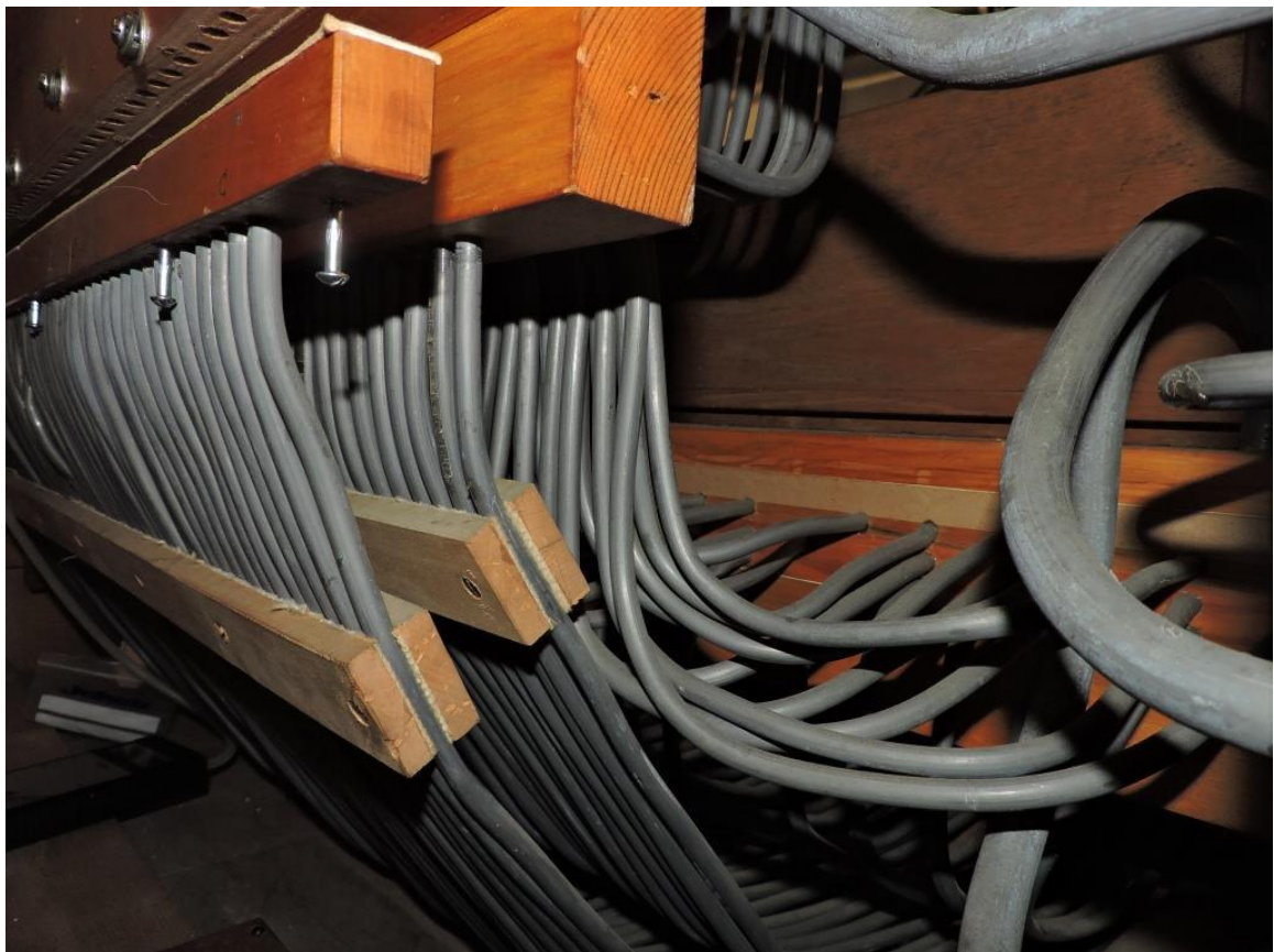
Abb. 267: Meggen LU, St. Charles Hall (Opus 557, 1924/1925), die Führung der pneumatischen Spieltraktur der Manuale (Bernhard Hörler).
