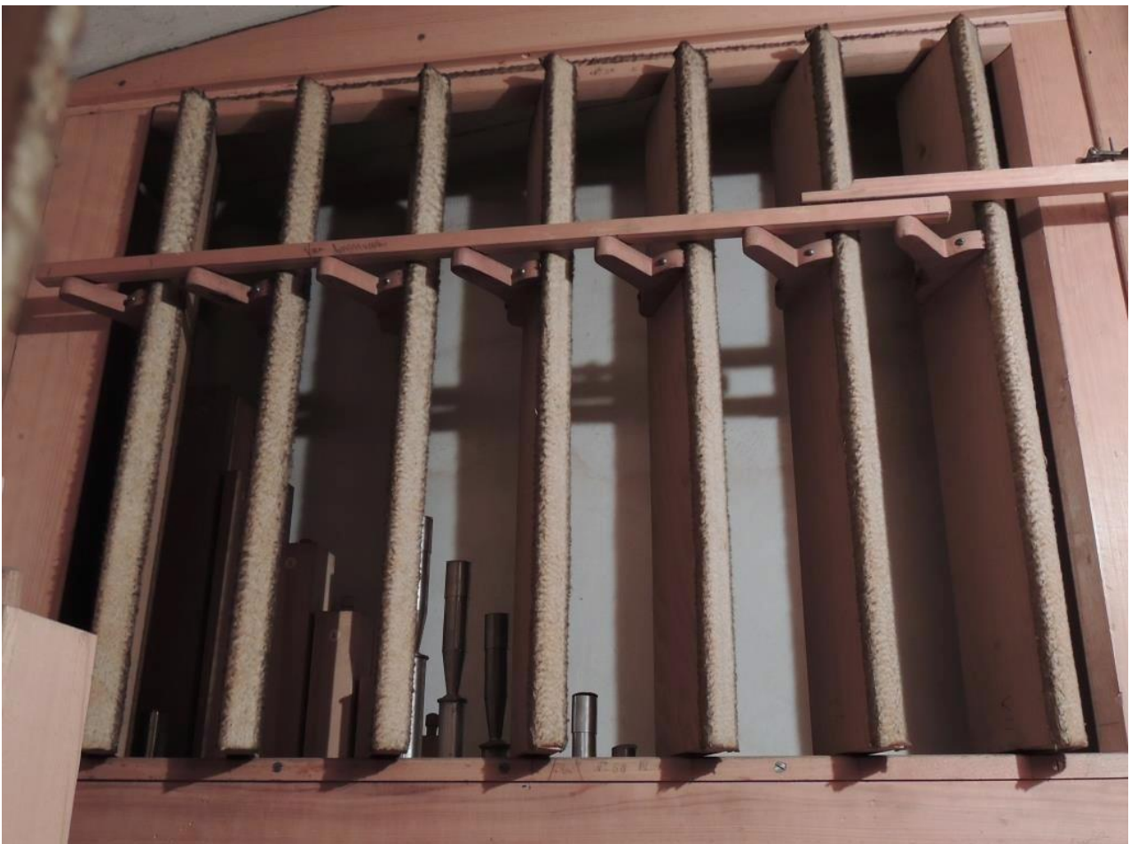
Abb. 83: Flawil SG (Opus 360 [361], 1911), der kleine Schwellkasten mit der Vox humana 8' und dem Lieblich Bourdon 8' im Schwellkasten des III. Manuals (Bernhard Hörler).
