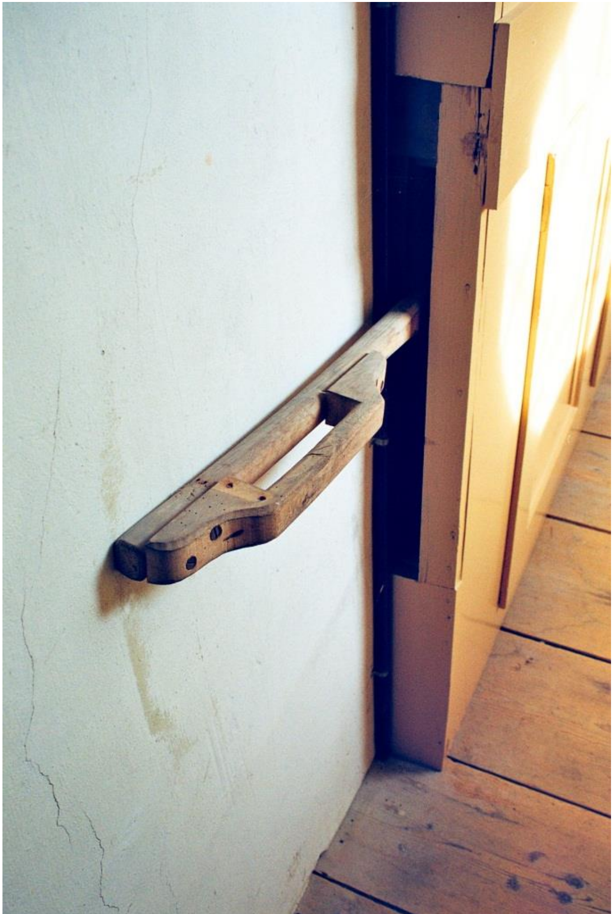
Abb. 307: La Ferrière BE (Opus 482, 1918), der Hebel für den Handbetrieb (Bernhard Hörler).
