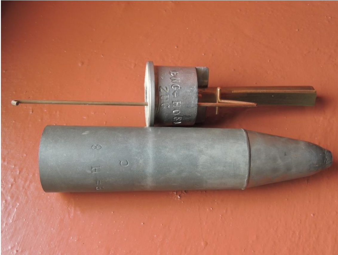
Abb. 59: Zug ZG, Institut St. Michael (Opus 357, 1910), Krummhorn 8', der klingende Teil der Pfeife C und die Stiefel-Vorderseite (Bernhard Hörler).
