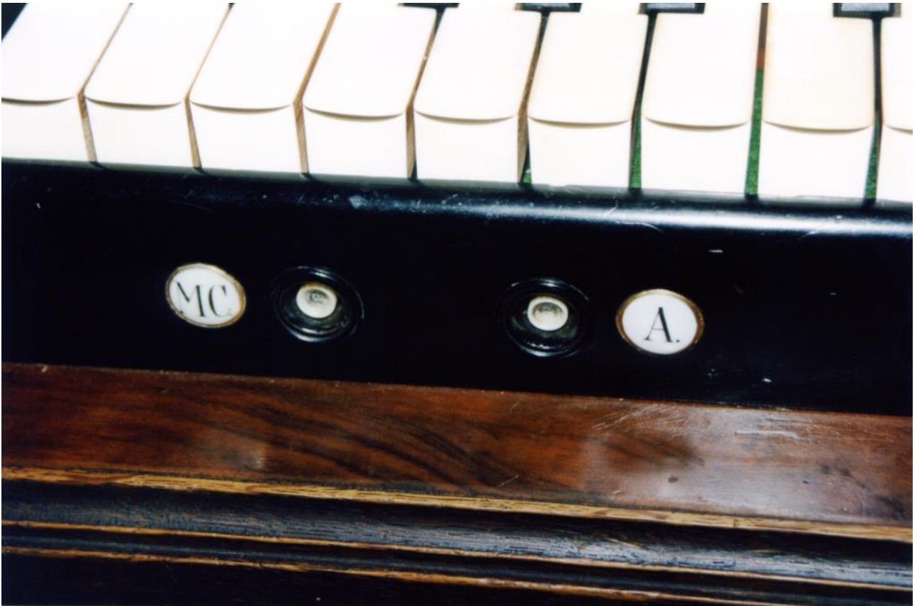
Abb. 62: Versoix GE (Opus 214, 1901), Manualkoppel als Druckknopf mit eigener Auslösung; 1968 stillgelegt und durch einen Tritt ersetzt (Bernhard Hörler).
