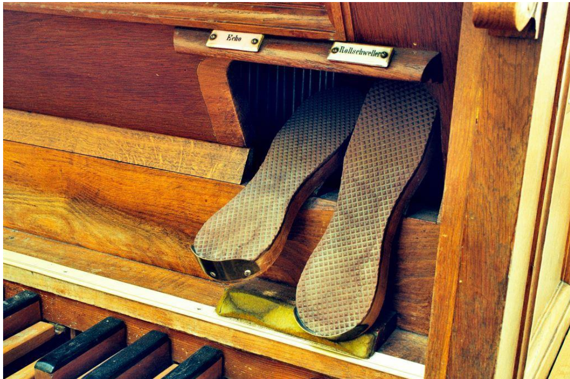
Abb. 73: Rueun (Ruis) GR (Opus 404, 1913), Balanciertritt zum Rollschweller (Bernhard Hörler).
