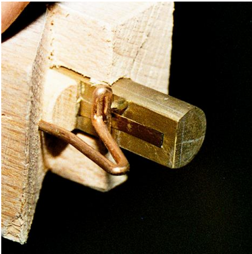
Abb. 37: Luzern LU, anglikanische Kirche (Opus 244, 1903), Clarinette 8' mit durchschlagenden Zungen, Detail (Bernhard Hörler).
