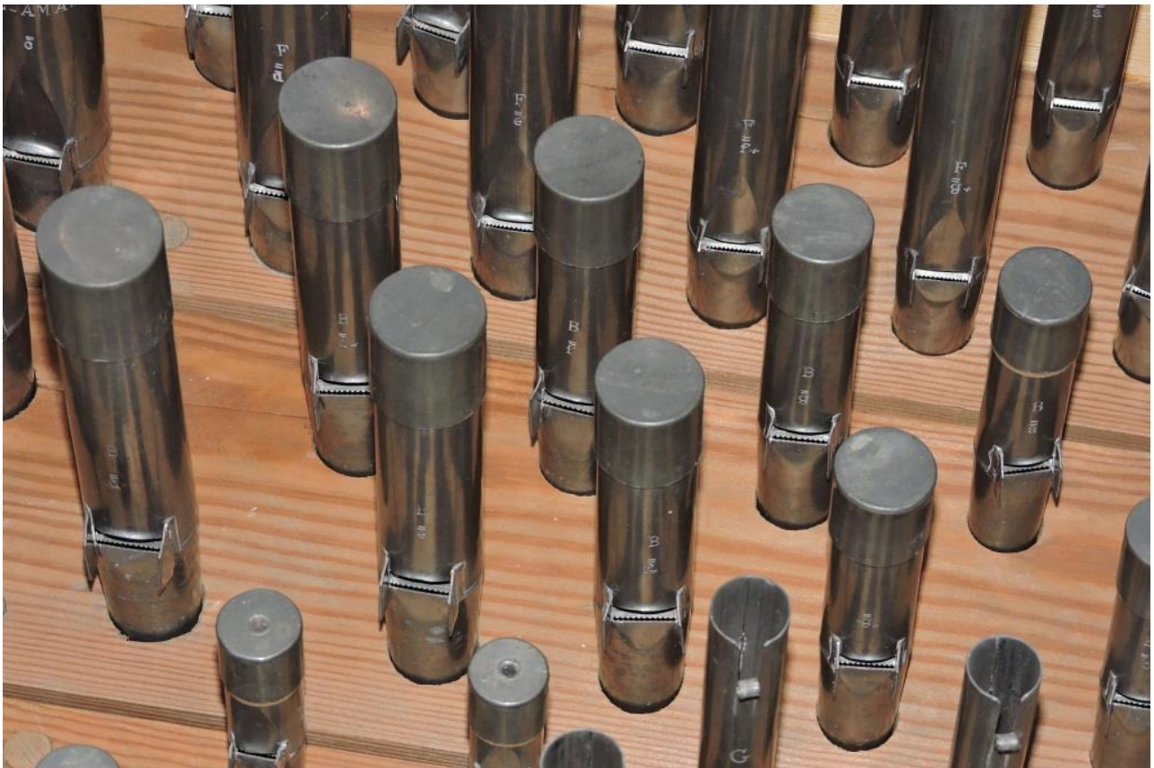
Abb. 19: Schwyz SZ, Kollegium (Opus 400, 1912/1913), Bourdon 8' im I. Manual mit den nach vorne gestülpten Oberlabien (Bernhard Hörler).
