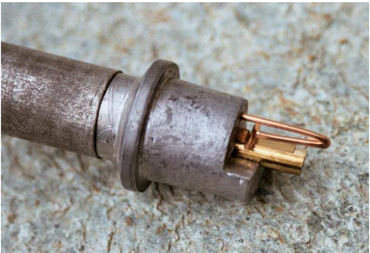
Abb. 39: Flawil SG, evangelische Kirche (Opus 360 [361], 1911, Clarinette 8' mit aufschlagenden Zungen (Bernhard Hörler).
