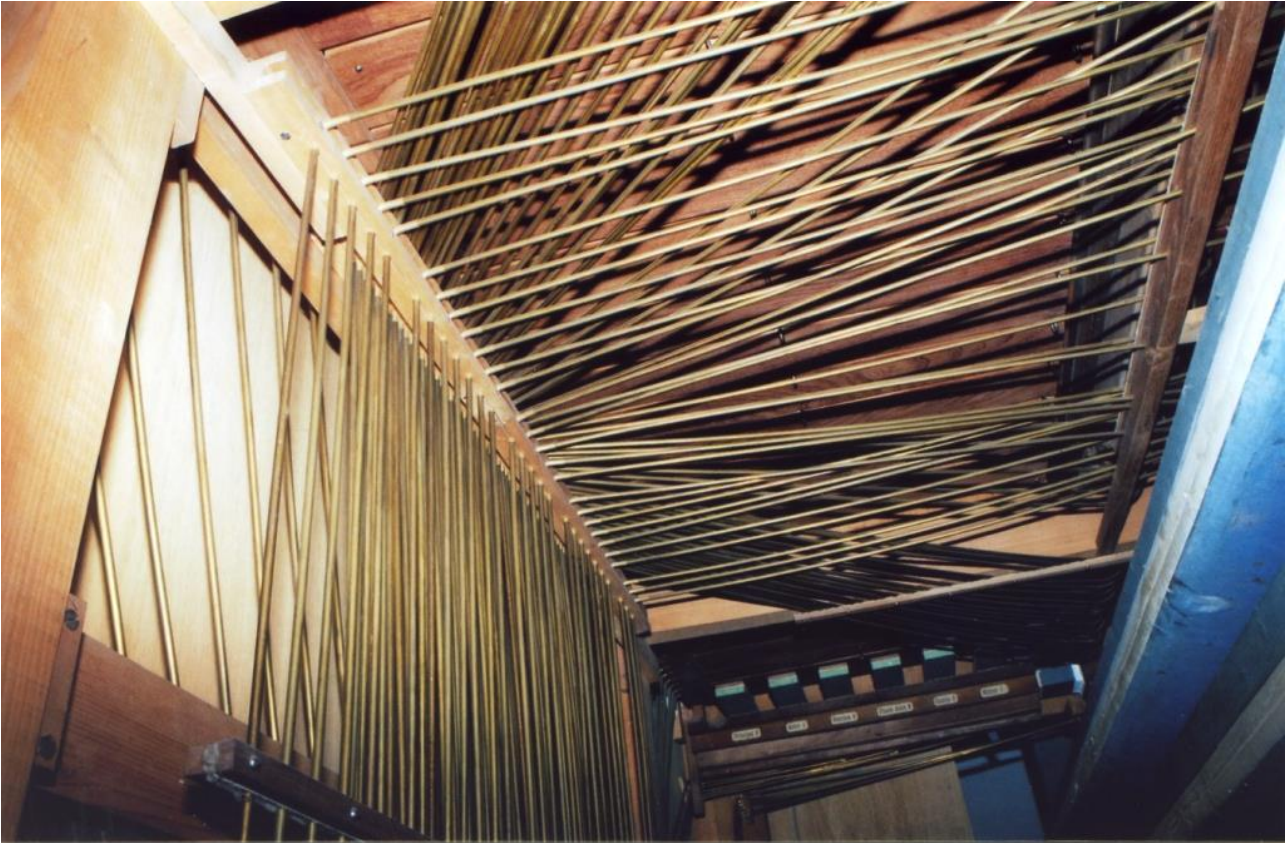
Abb. 158: Haute-Nendaz VS (Opus 182, 1898), die Messingröhrenstruktur der für Basse-Nendaz VS erbauten Orgel von Friedrich Goll (Bernhard Hörler).
