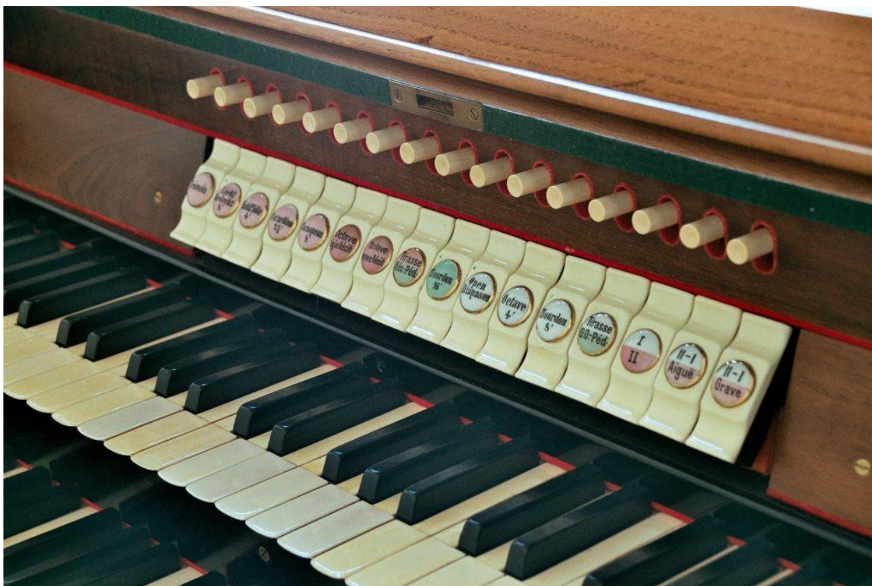
Abb. 254: Villars-le-Compte VD, reformierte Kirche, ehemals Vevey VD, anglikanische Kirche (Opus 343, 1909), Spieltisch mit Wippen für die Handregister und Druckknöpfen für die freie Kombination (Bernhard Hörler).
