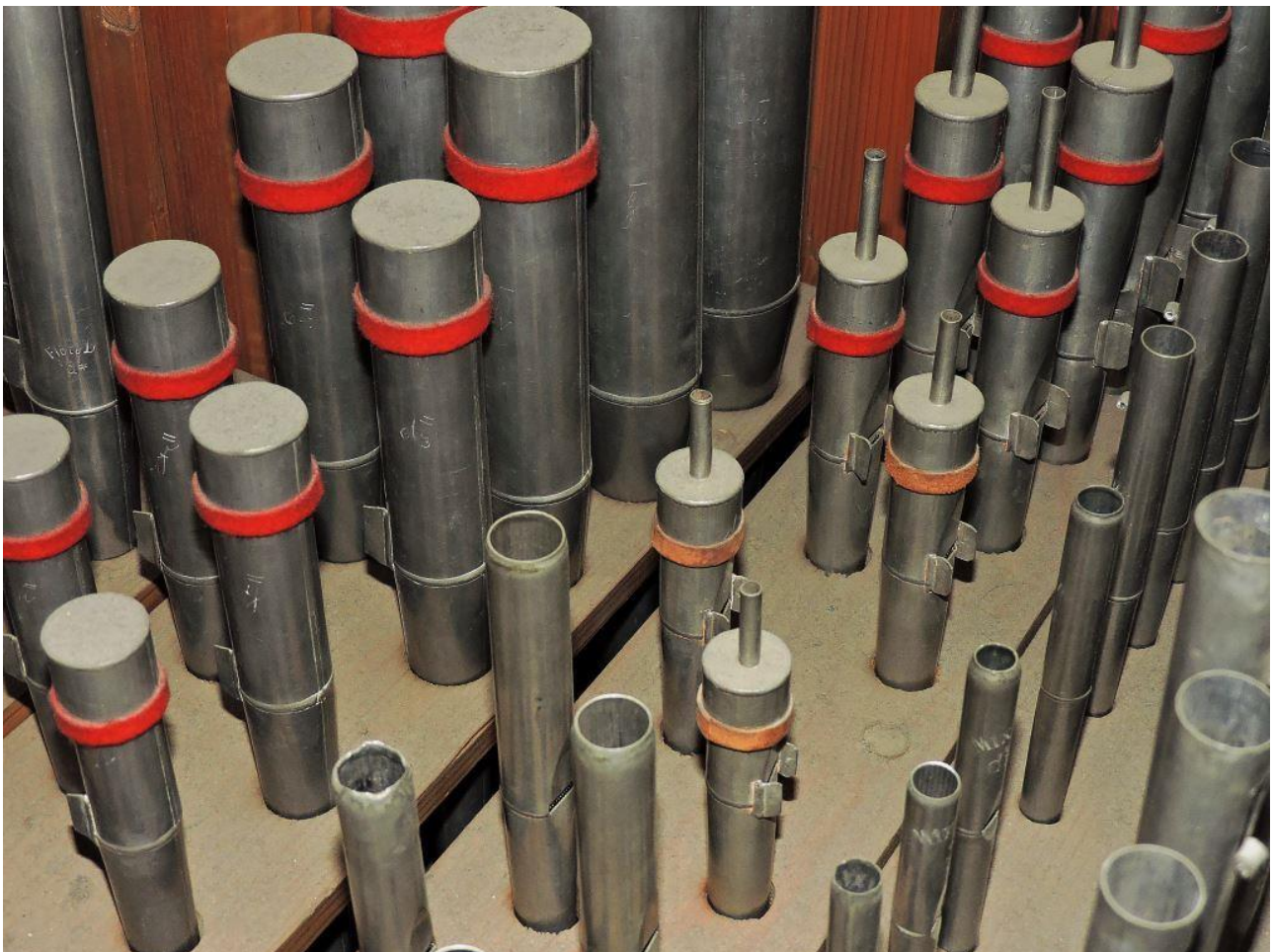
Abb. 22: Zürich ZH, evangelische St. Annakapelle (Opus 352, 1910), Rohrflöte 4' im I. Manual mit sichtbaren Röhrrchen (Bernhard Hörler).
