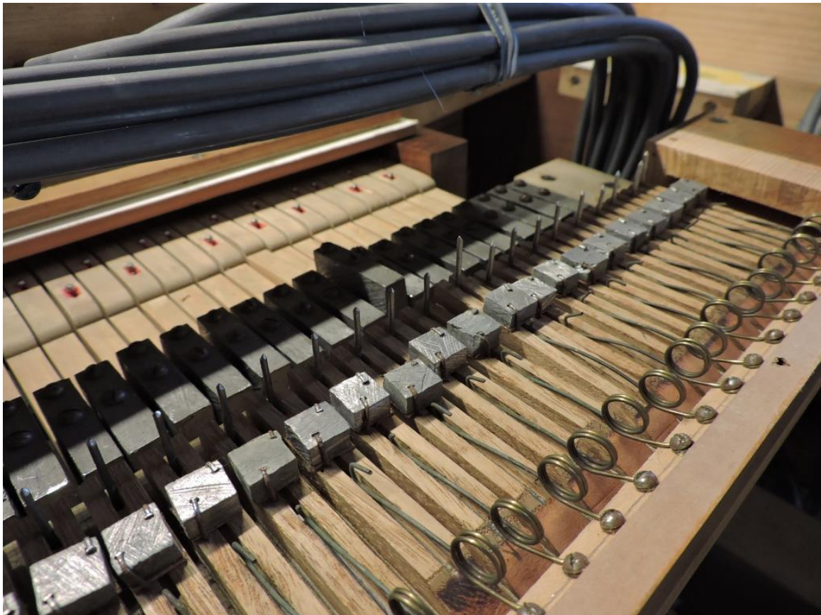
Abb. 266: Meggen LU, St. Charles Hall (Opus 557, 1924/1925), der hinterste Teil der Tasten mit weiteren aufgeschraubten Bleiklötzchen zur Regulierung des Spielgewichts (Bernhard Hörler).
