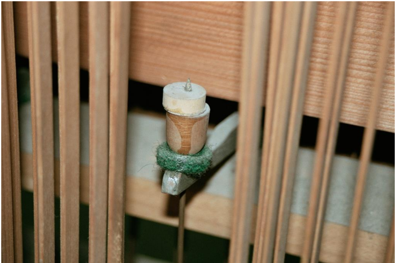
Abb. 214: Werthenstein LU, Wallfahrtskirche (Opus 128, 1894), Detail des Mechanismus des Kombinationstrittes F. (Bernhard Hörler).
