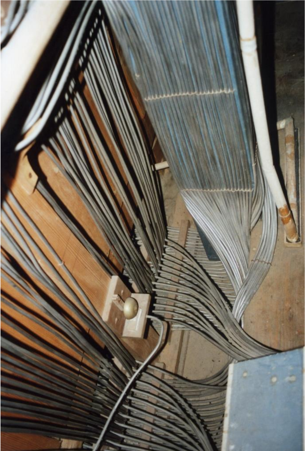
Abb. 168: Le Crêt FR (Opus 252, 1904): Die pneumatische Traktur und das Calcantenglöckchen (Bernhard Hörler).
