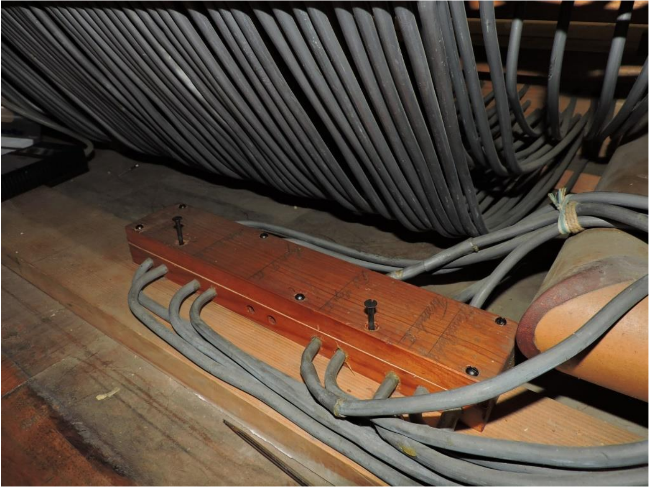
Abb. 268: Meggen LU, St. Charles Hall (Opus 557, 1924/1925), die Station im Spieltisch für die Pedalkoppeln und das Tremolo (Bernhard Hörler).
