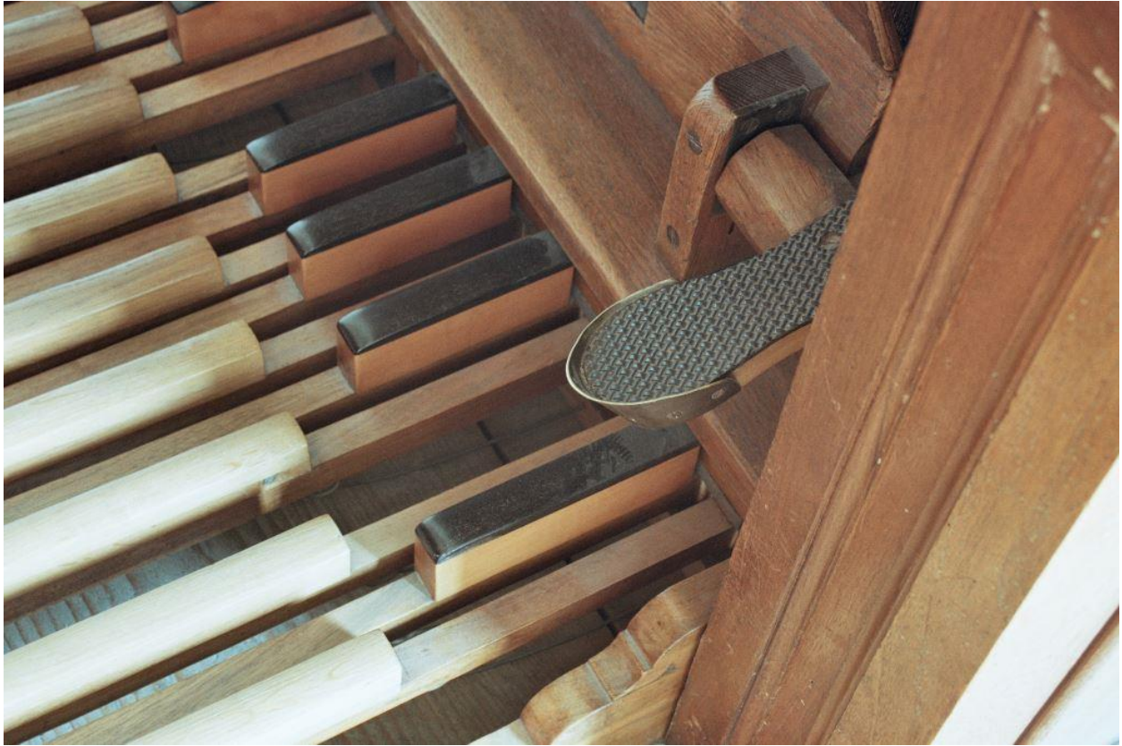
Abb. 203: Sarnen OW, Kollegium (Opus 97, 1891), der sohlenförmige Schwelltritt mit achteckiger Rolle und engerer Ferse (Bernhard Hörler).
