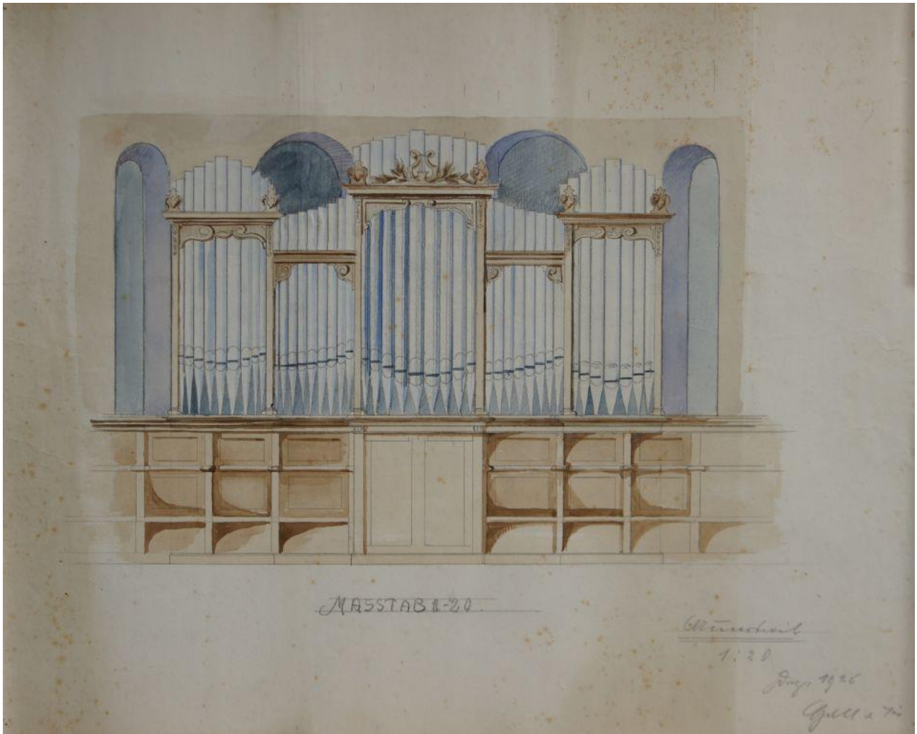
Abb. 140: Ammerswil AG: Nicht ausgeführter, von Karl Goll persönlich signierter Prospektentwurf mit asymmetrischer Labienführung in den beiden kleineren Feldern vom Dezember 1926 (ref. Kirchgemeindearchiv Ammerswil in Dottikon).
