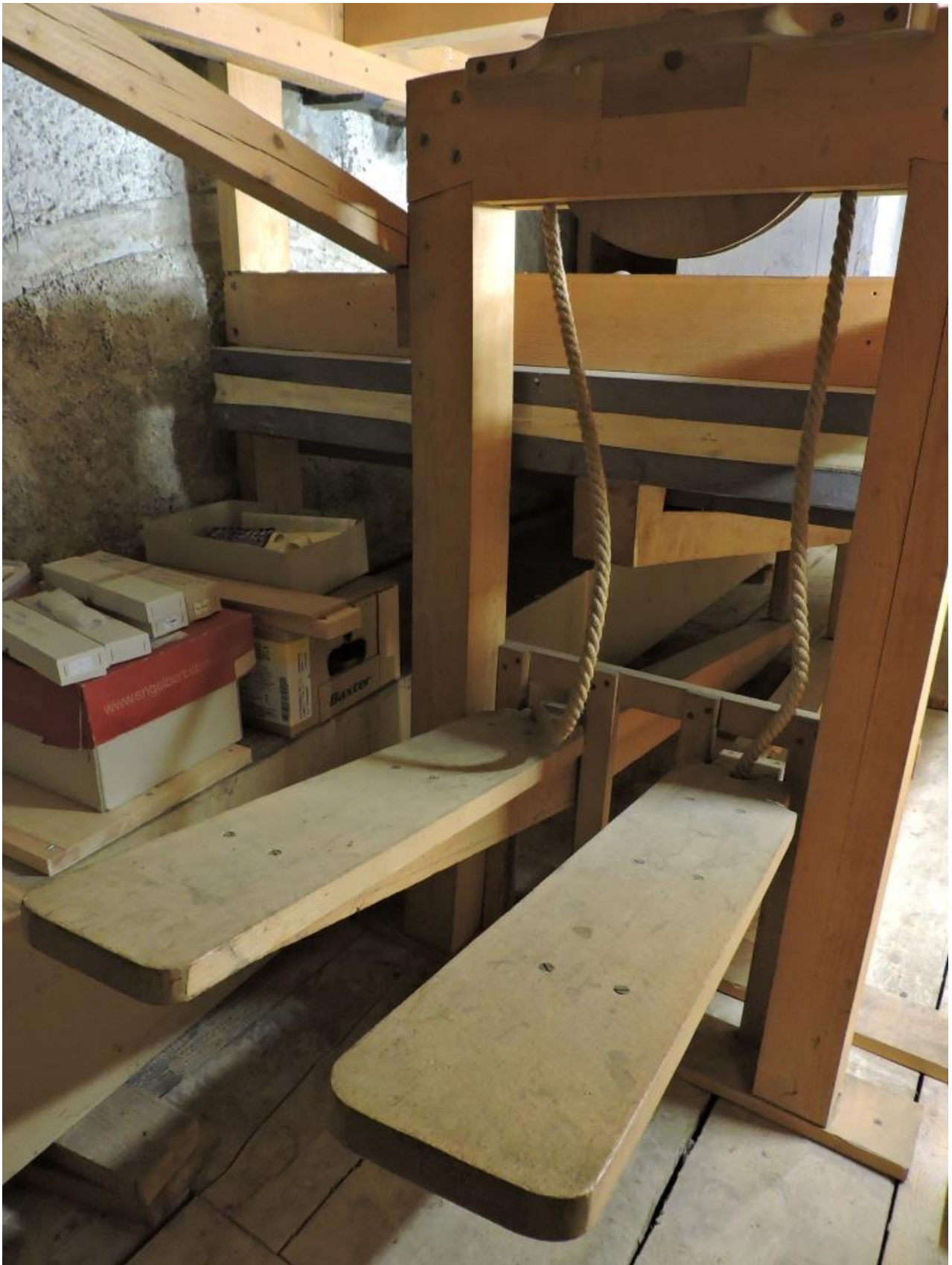
Abb. 295: Schwyz SZ, Kollegium (Opus 400, 1912/1913), Tretvorrichtung mit zwei Schöpfern (Bernhard Hörler).
