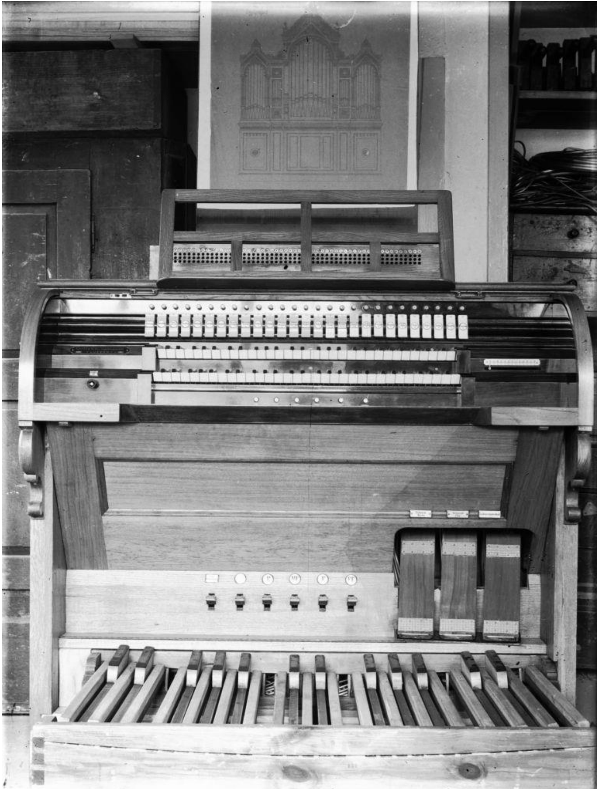
Abb. 230: Stans NW, Kloster St. Klara (Opus 491, 1919), der Spieltisch für die erweiterte Orgel mit weiter auseinander liegenden Registerwippen (Familienarchiv Goll).
