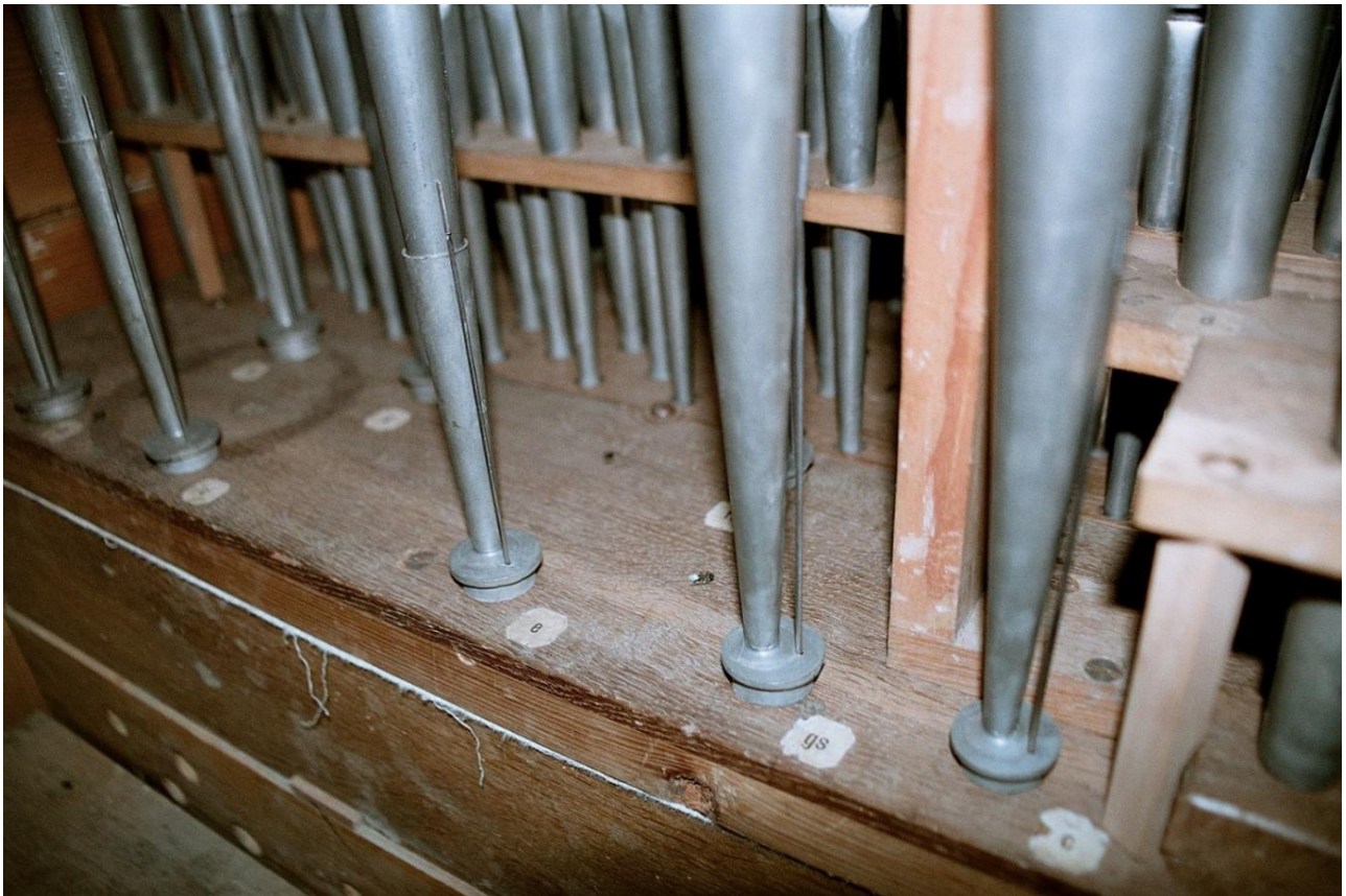
Abb. 27: Hundsbach im Elsass (Opus 96, 1891), ohne Stiefel direkt im Stock steckende Trompete 8' von (Bernhard Hörler).
