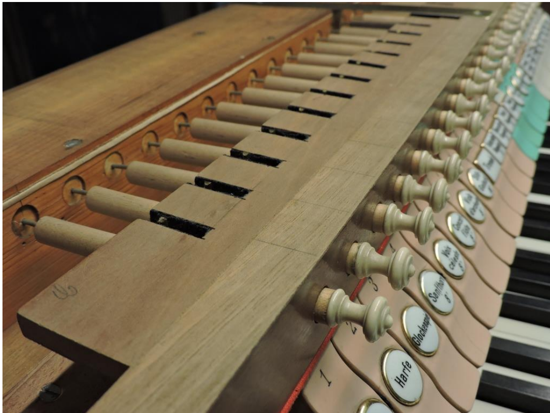
Abb. 262: Meggen LU, St. Charles Hall (Opus 557, 1924/1925), Blick auf die Registerstaffelei mit den gedrechselten Zügeln für die freie Kombination (Bernhard Hörler).
