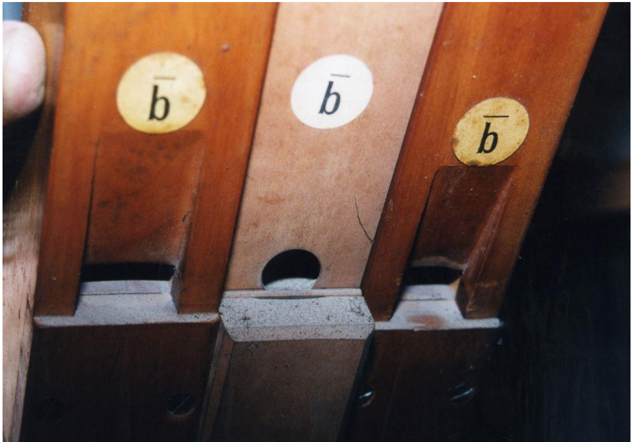
Abb. 14: Verscio TI (Opus 220, 1902), drei verschiedene Holzregister – in der Mitte Flauto-amabile 8' mit dem von aussen angeblasenen Kreislabium (Bernhard Hörler).
