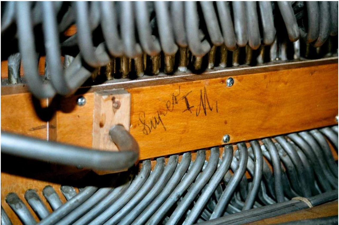
Abb. 260: Niederrickenbach NW (Opus 478, 1918). Sorgfältige Arbeit im Innern des Spieltischs, hier die Superoctav-Kopplung im I. Manual (Bernhard Hörler).
