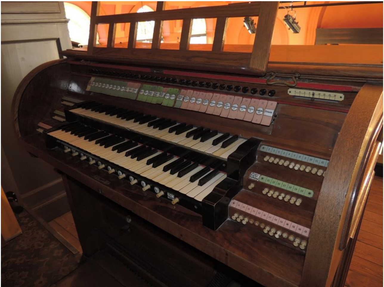
Abb. 228: Zug ZG, Institut St. Michael (Opus 357, 1910), Gesamtansicht des Spieltischs mit der ungewöhnlich angelegten Registratur für die Handregister und für die drei freien Kombinationen (Bernhard Hörler).
