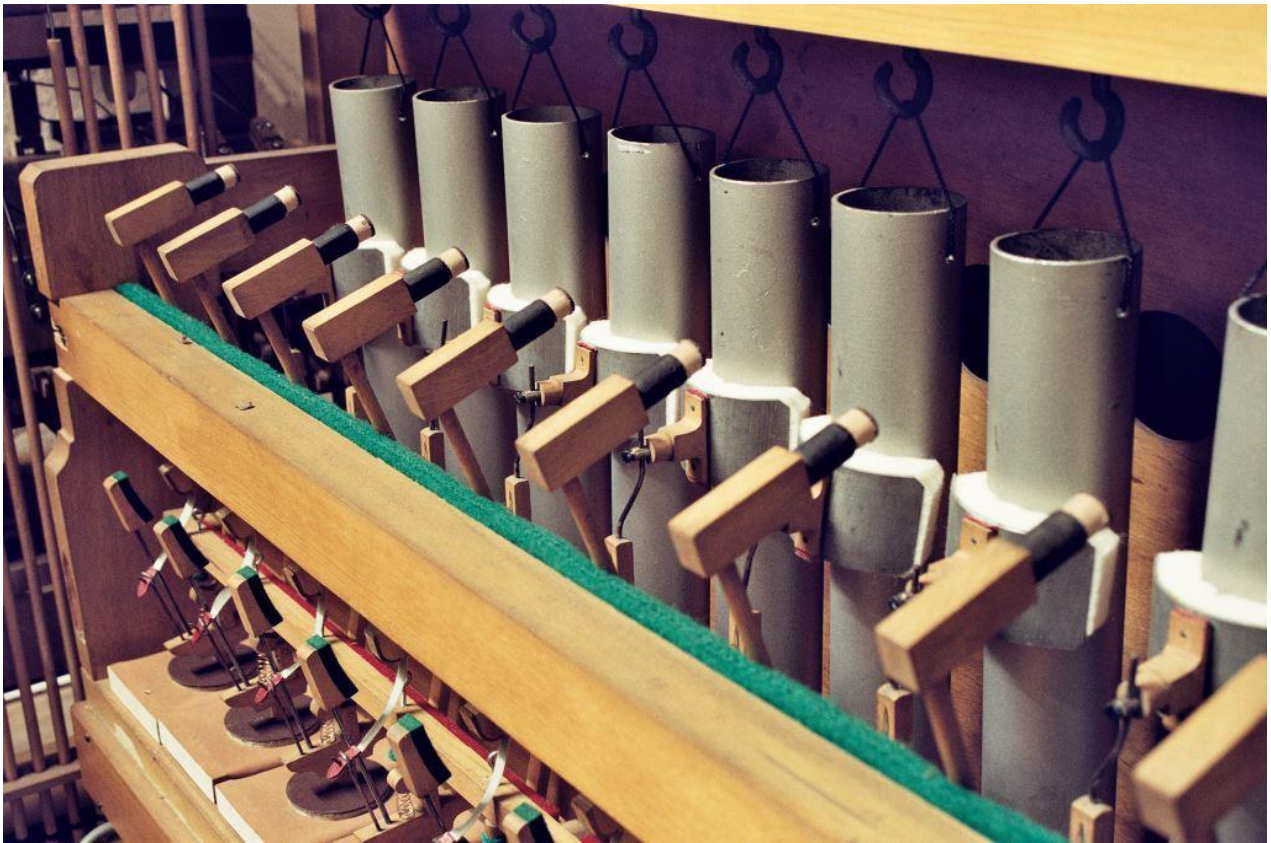
Abb. 92: Meggen LU, St. Charles Hall (Opus 557, 1924/1925), die Hämmerchen, Dämpfer und aufgehängten Röhren des von der Firma Goll selbst konstruierten Glockenspiels nach der Restaurierung im Jahr 2016 (Bernhard Hörler).
