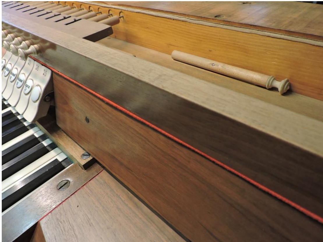
Abb. 264: Meggen LU, St. Charles Hall (Opus 557, 1924/1925), ein original hier platziertes Reserve-Züglein für die freie Kombination (Bernhard Hörler).
