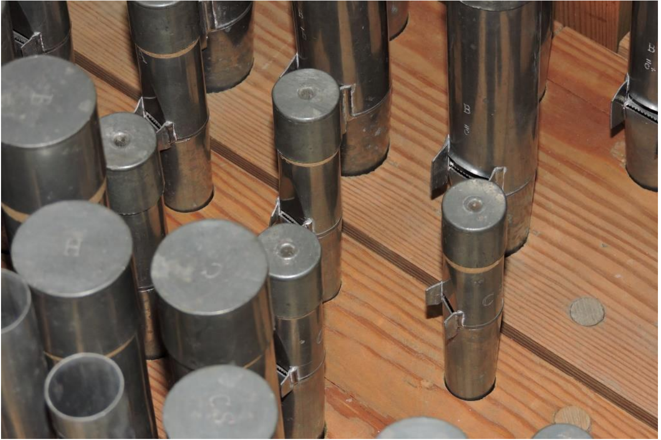
Abb. 23: Schwyz SZ, Kollegium (1912/1913), Rohrflöte 4' im I. Manual mit inwendigen Röhrchen (Bernhard Hörler).
