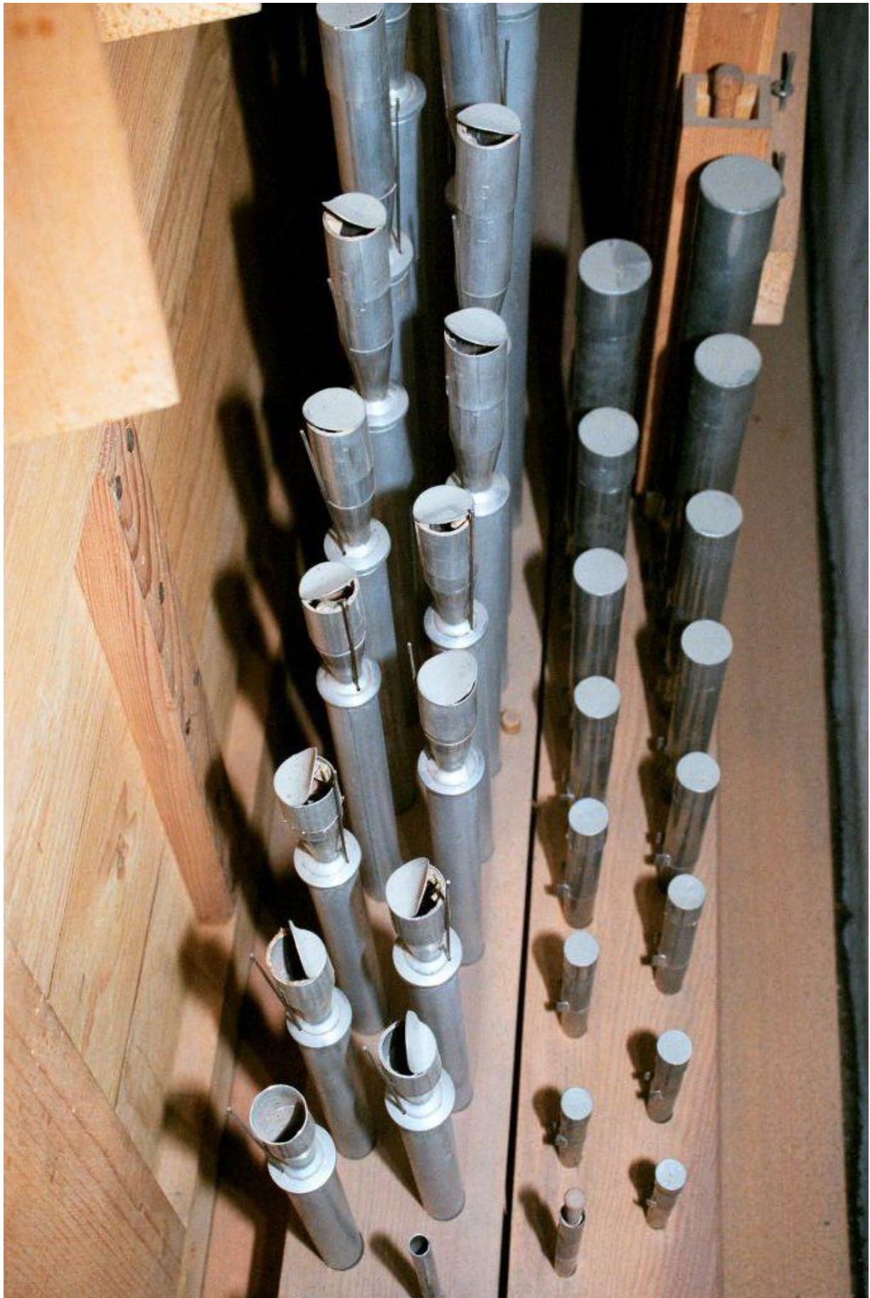
Abb. 84: Flawil SG (Opus 360 [361], 1911), Vox humana 8' und Lieblich Bourdon 8' im besonderen Schwellkasten (Bernhard Hörler).
