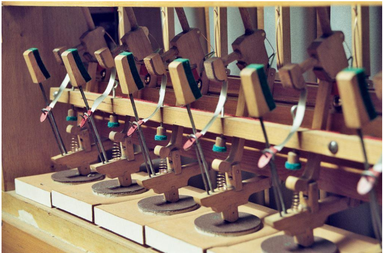
Abb. 93: Meggen LU, St. Charles Hall (Opus 557, 1924/1925), die pneumatisch gesteuerte Mechanik des von der Firma Goll selbst konstruierten Glockenspiels nach der Restaurierung im Jahr 2016 (Bernhard Hörler).
