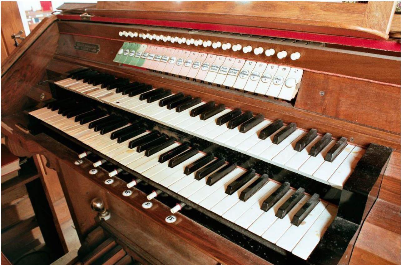
Abb. 256: Château d'Oex VD, anglikanische Kirche (Opus 462, 1916/1917), die Wippen für die Handregister und die Züglein für die freie Kombination (Bernhard Hörler).
