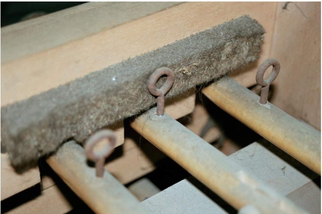
Abb. 213: Werthenstein LU, Wallfahrtskirche (Opus 128, 1894), Stossdämpfer für die Registerzüge des II. Manuals (Bernhard Hörler).
