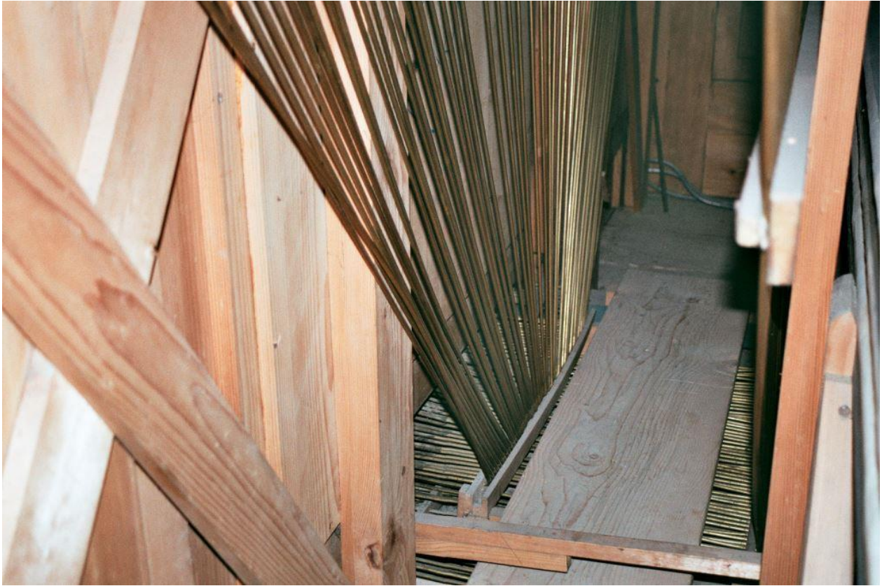
Abb. 150: Vaulruz FR (Opus 152, 1896), die pneumatische Messingröhrenstruktur (Bernhard Hörler).
