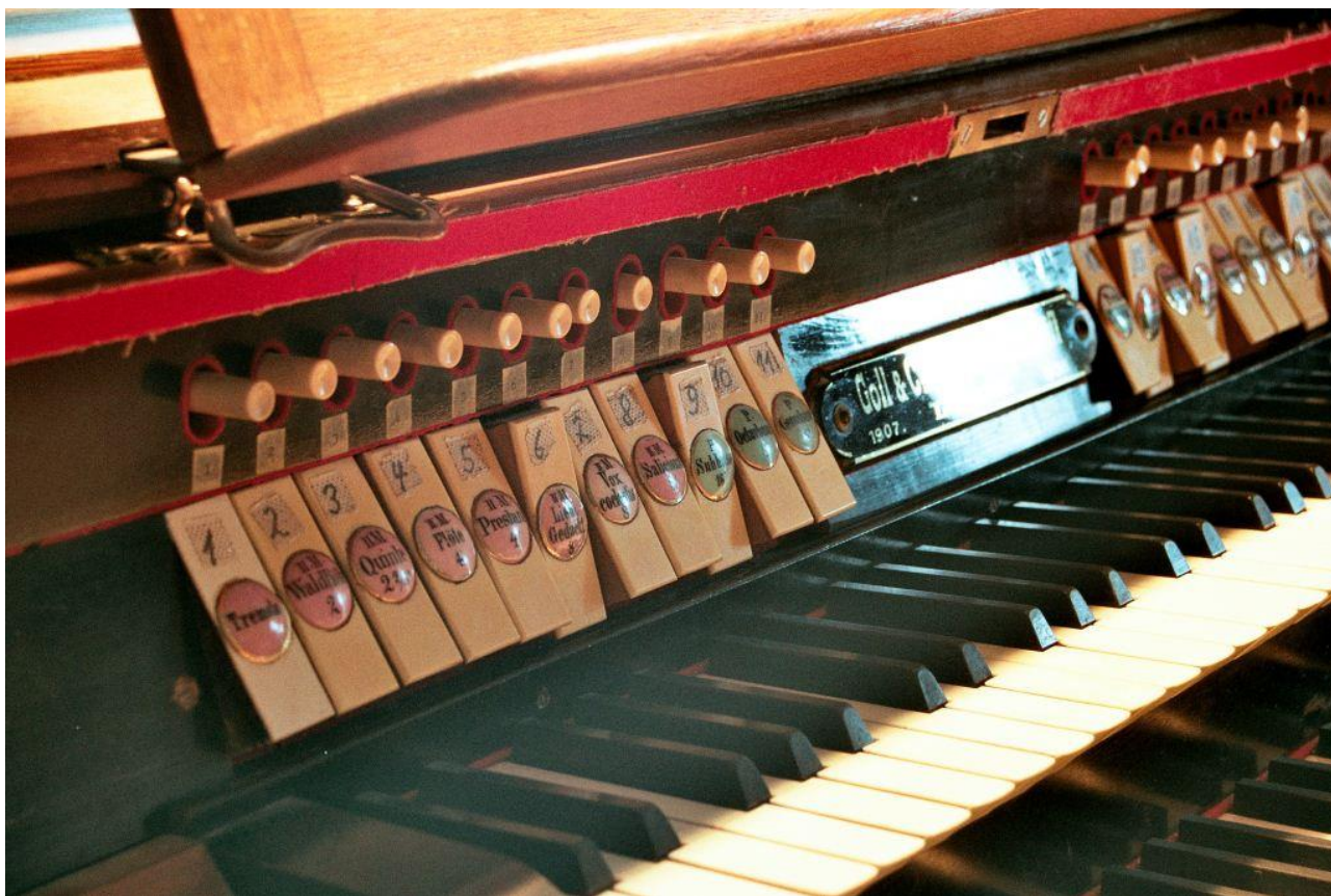
Abb. 225: Das 1907 gebaute Spieltischmodell von Goll & C. mit den Druckknöpfen für die freie Kombination anstelle der sonst üblichen Züglein, hier in Reitnau AG (Bernhard Hörler).
