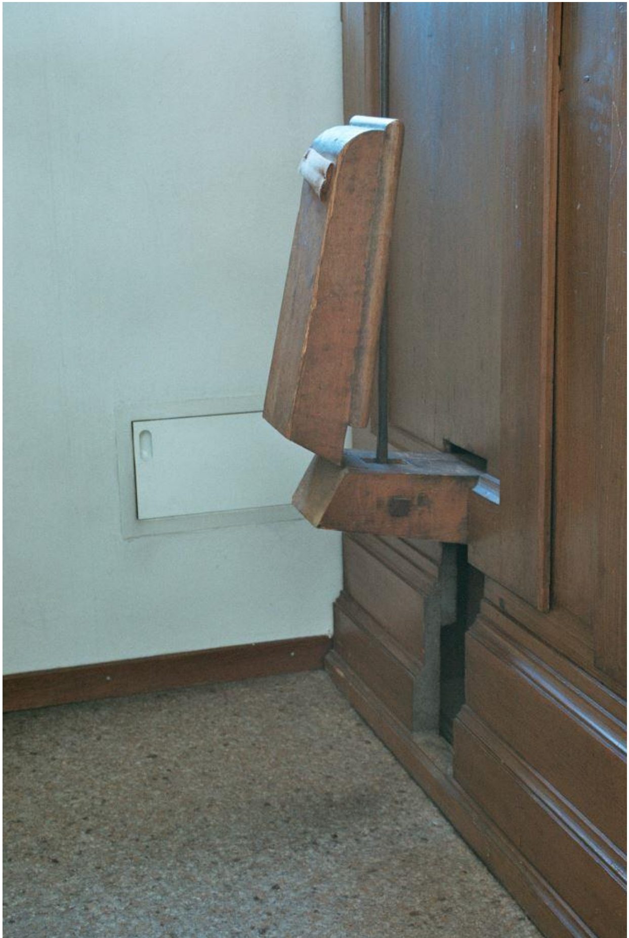
Abb. 293: Attinghausen UR (Opus 111, 1893), die einklappbare Tretvorrichtung (Bernhard Hörler).
