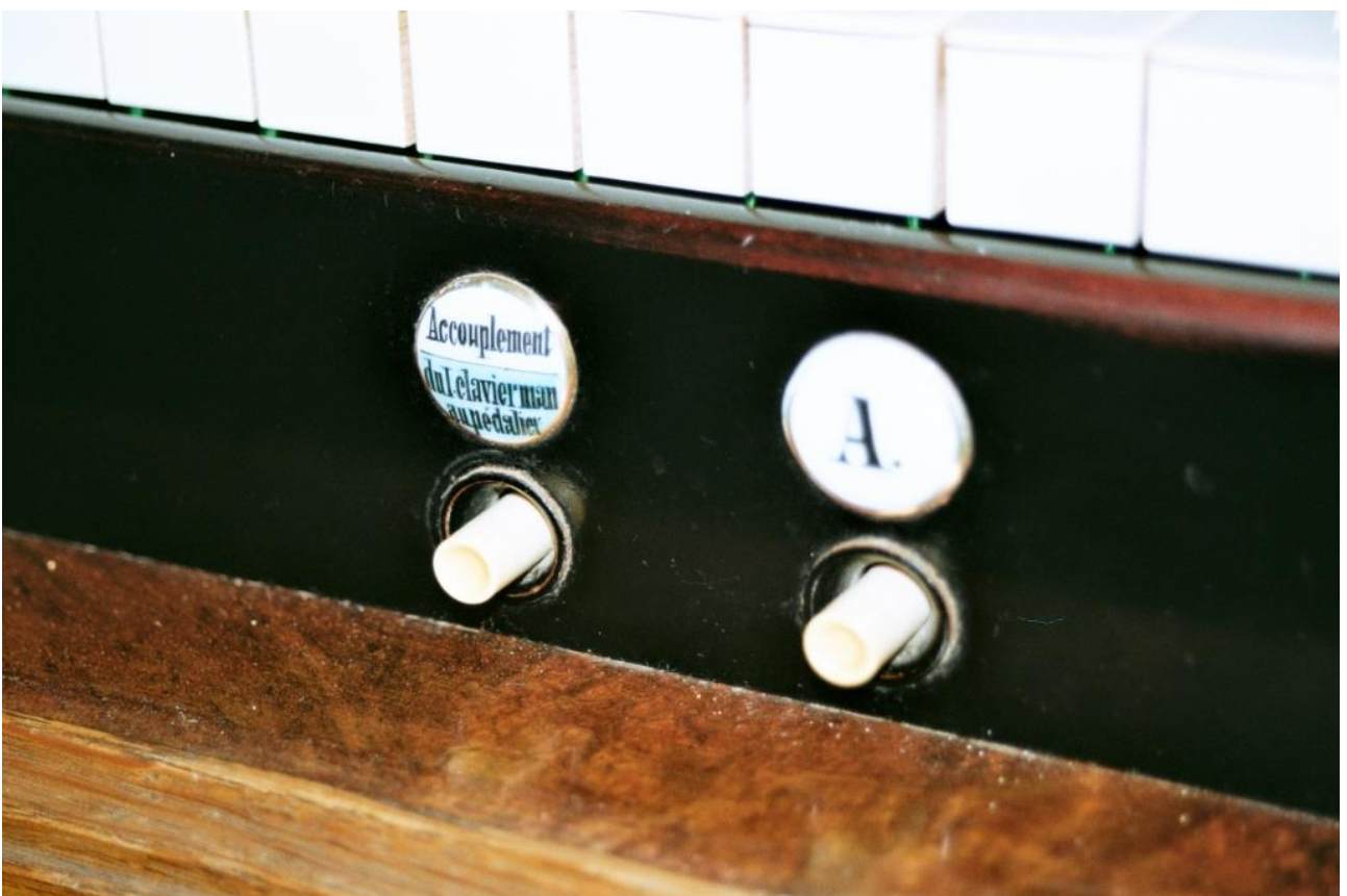
Abb. 63: Le Crêt FR (Opus 252, 1904), Pedalkopplung zum I. Manual mit eigener Auslösung (Bernhard Hörler).
