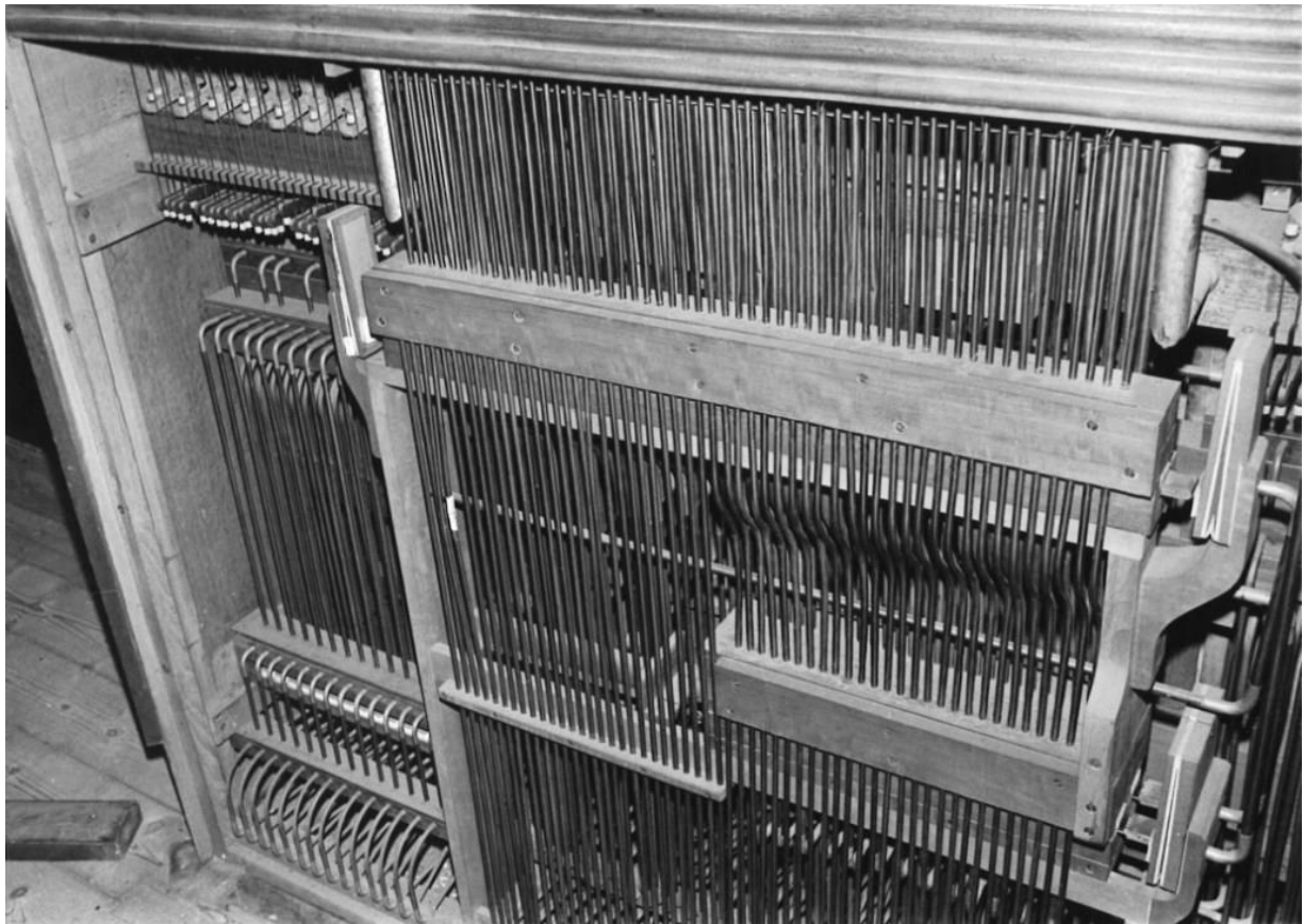
Abb. 152: Luzern LU, Jesuitenkirche (Opus 162, 1897), Führung der Traktur im Spieltisch (Zentralbibliothek Zürich, Musikabteilung, Nachlass Jakob Kobelt).
