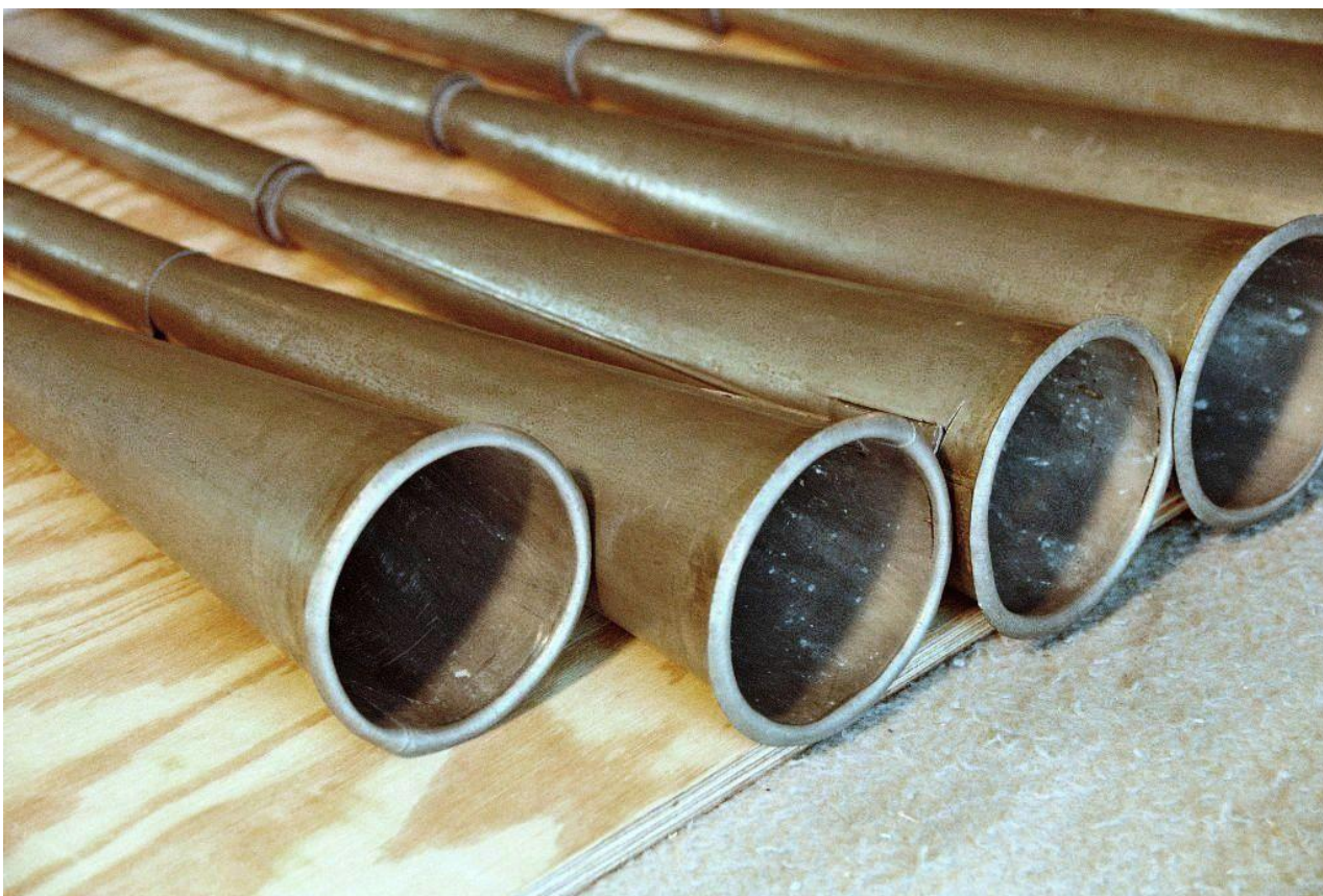
Abb. 26: Meggen LU, katholische Pfarrkirche St. Magdalena (Opus 77, 1889), Becherkonstruktion der Trompete 8' (Bernhard Hörler).
