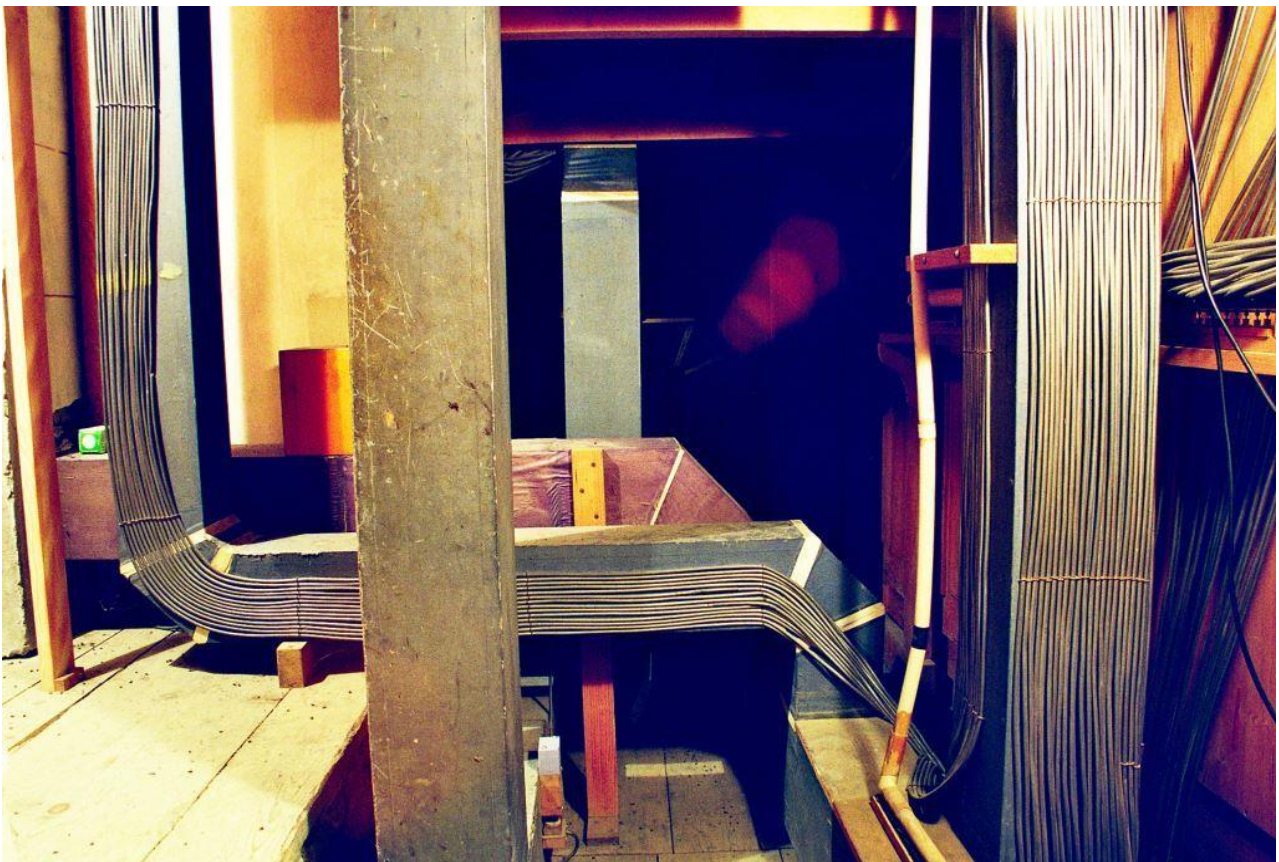
Abb. 167: Le Crêt FR (Opus 252, 1904): Die saubere Trakturführung der Taschenladenorgel, eines der letzten noch unter Friedrich Goll erstellten Werke (Bernhard Hörler).
