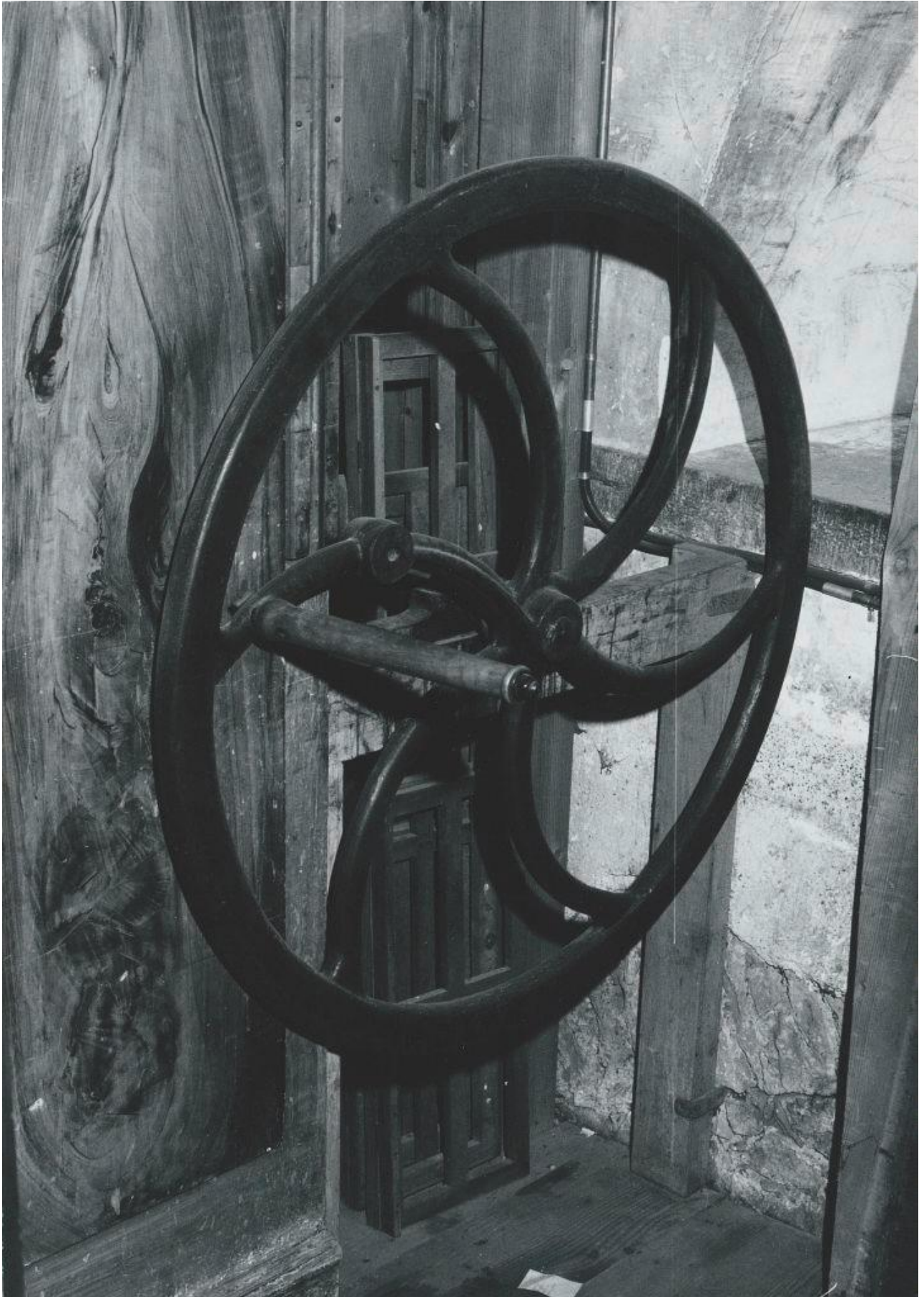
Abb. 300: Knutwil LU, das durch Friedrich Goll im Jahr 1895 eingebaute Schwungrad (Zentralbibliothek Zürich, Nachlass Jakob Kobelt).
