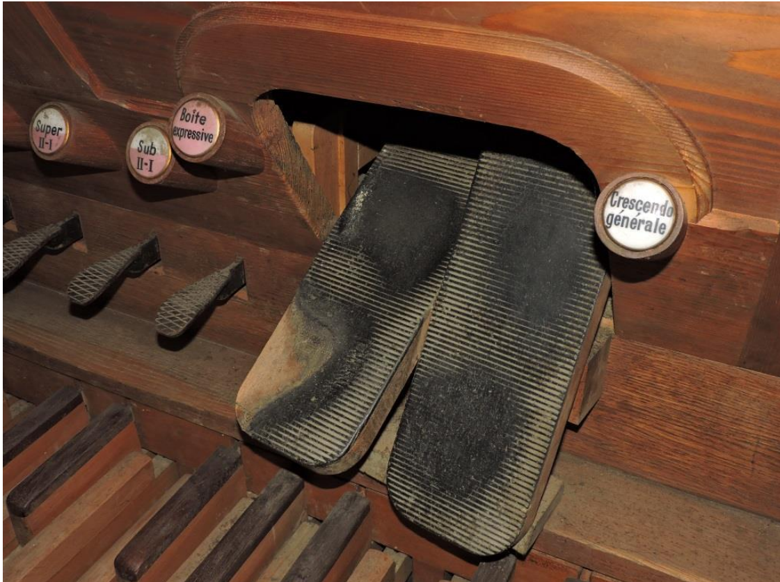
Abb. 168: Grentzingen (Elsass), Balanciers für den Echokasten und das Generalcrescendo im Spieltisch der Orgel von Georges Schwenkedel von 1931 (Bernhard Hörler).
