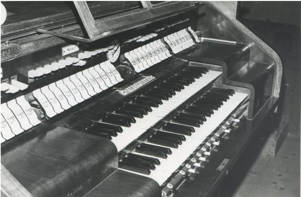
Abb. 29: Kleinwangen LU, der Spieltisch der Orgel von Beiler & Bader von 1910 mit der Transponiervorrichtung (Kantonale Denkmalpflege Luzern, Jakob Kobelt).
