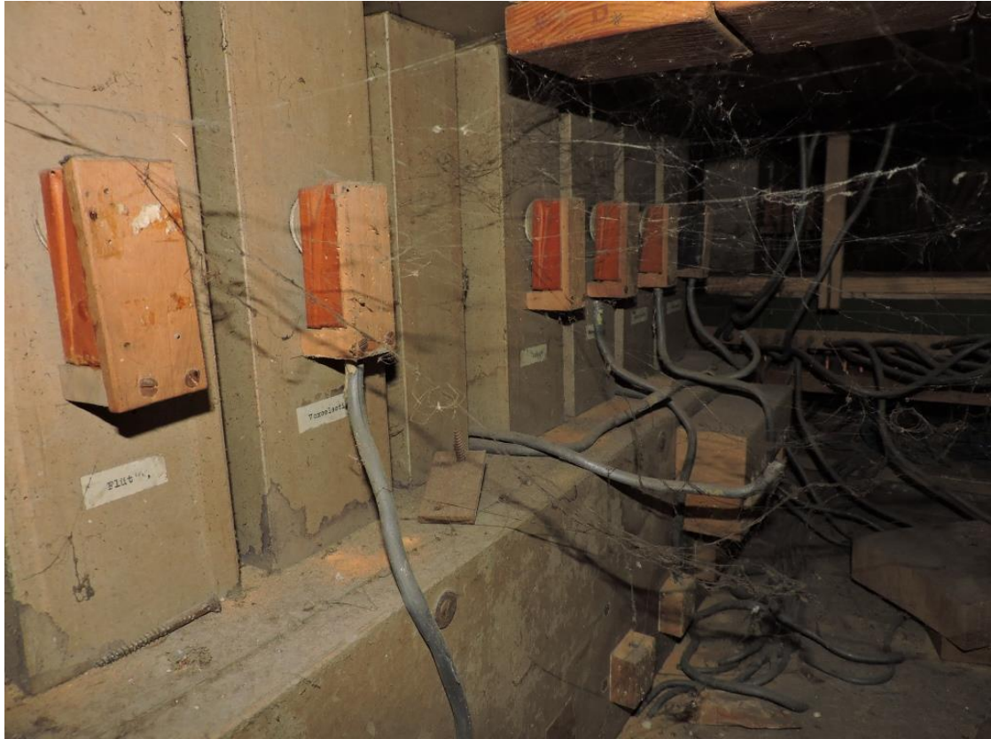
Abb. 138: Liebenswiller (Elsass), katholische Pfarrkirche St-Marc, Registerbälgchen und Pneumatik im Unterbau der Orgel von Jules Besserer von 1925 (Bernhard Hörler).
