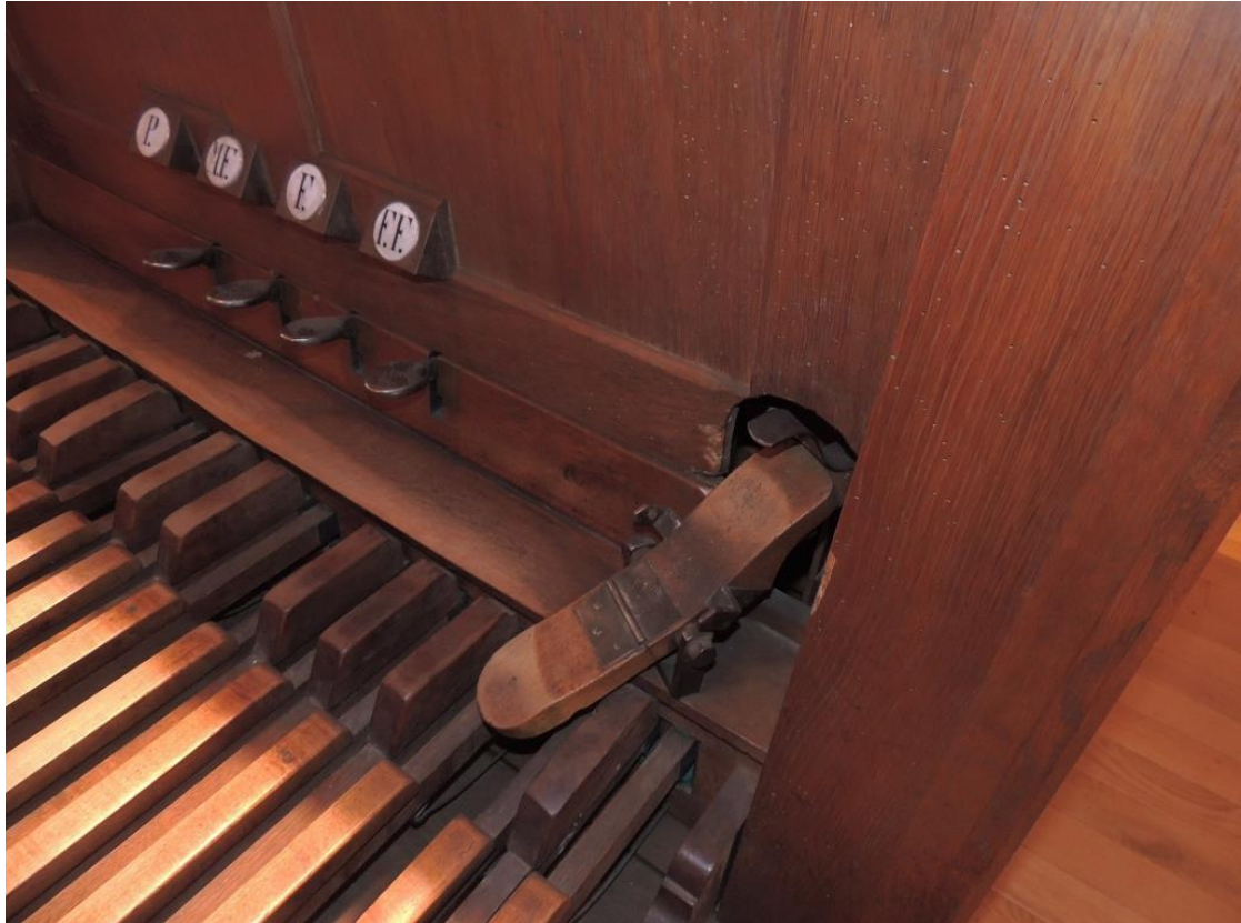
Abb. 57: Der Schwelltritt der Orgel von Jakob Zimmermann in Jettingen im Elsass im betriebsbereiten Zustand (Bernhard Hörler).
