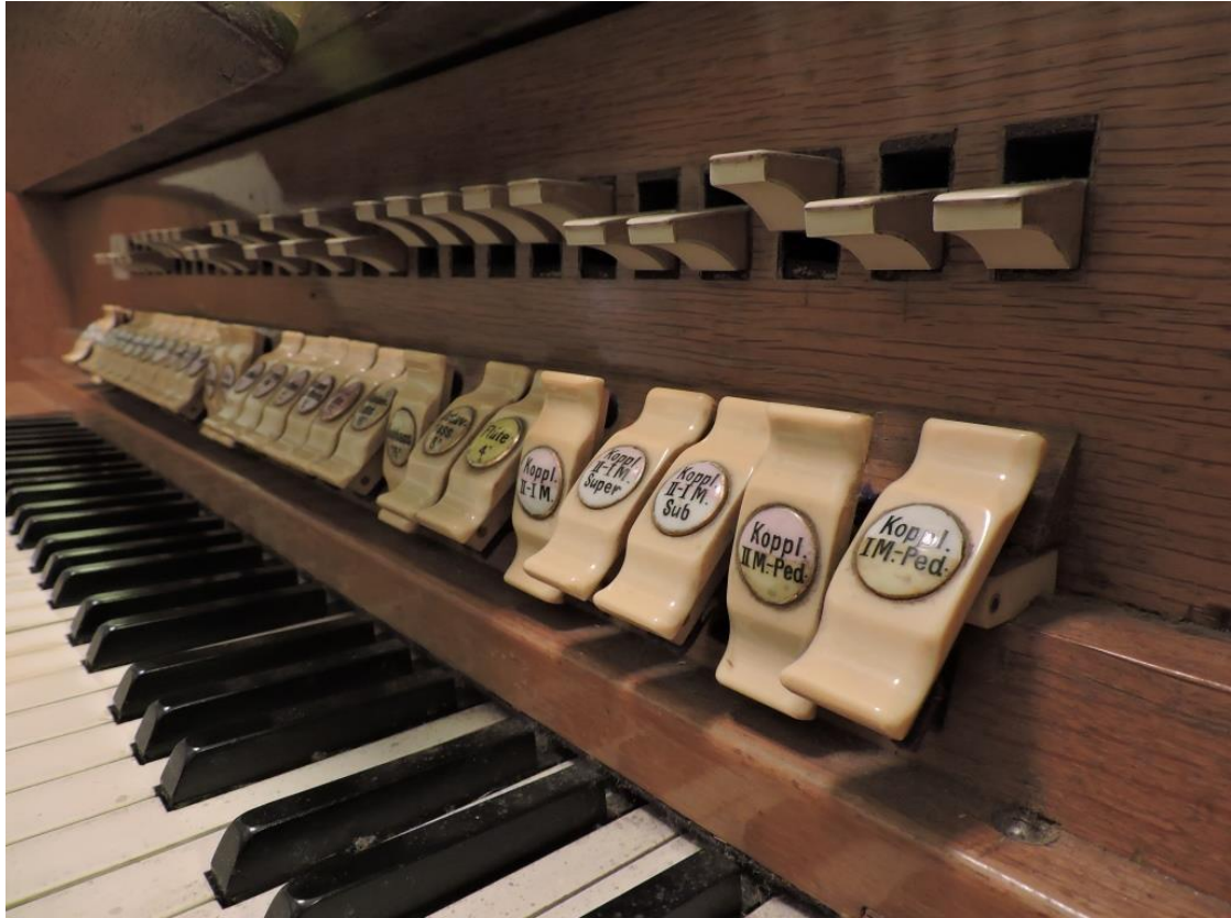
Abb. 142: Goldbach-Altenbach (Elsass), katholische Pfarrkirche St-Laurent, Registerstaffelei im Spieltisch der Orgel von Jules Besserer von 1927 (Bernhard Hörler).
