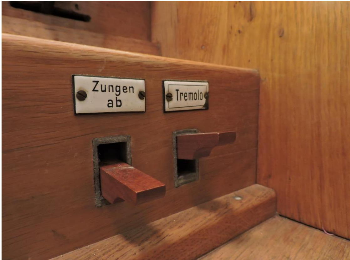
Abb. 143: Goldbach-Altenbach (Elsass), katholische Pfarrkirche St-Laurent, Kipptasten für den Zungenabsteller und das Tremolo im Spieltisch der Orgel von Jules Besserer von 1927 (Bernhard Hörler).
