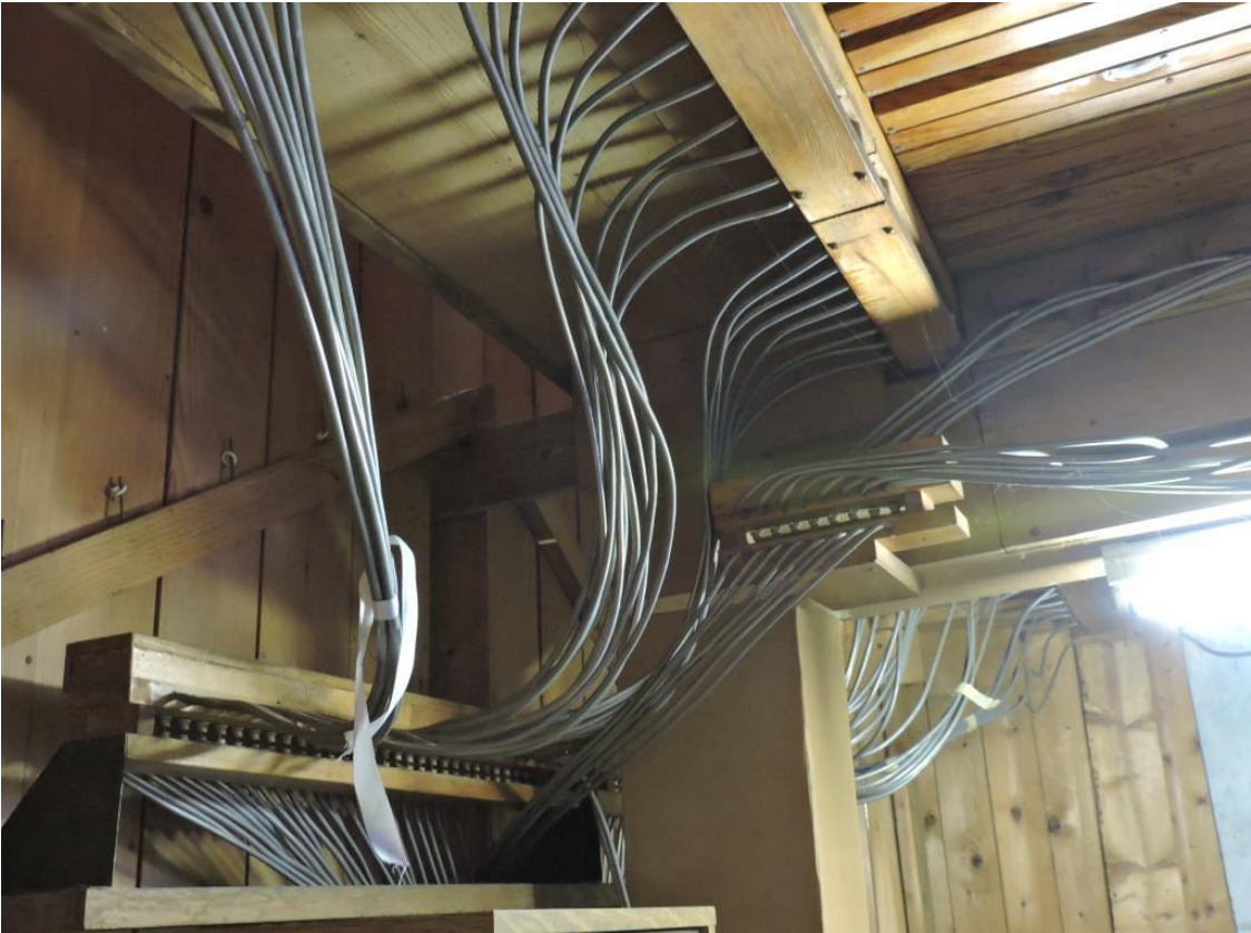
Abb. 131: Pfterthouse (Elsass), katholische Pfarrkirche St-Géréon, Pneumatik der Orgel von Jules Besserer von 1924 (Bernhard Hörler).
