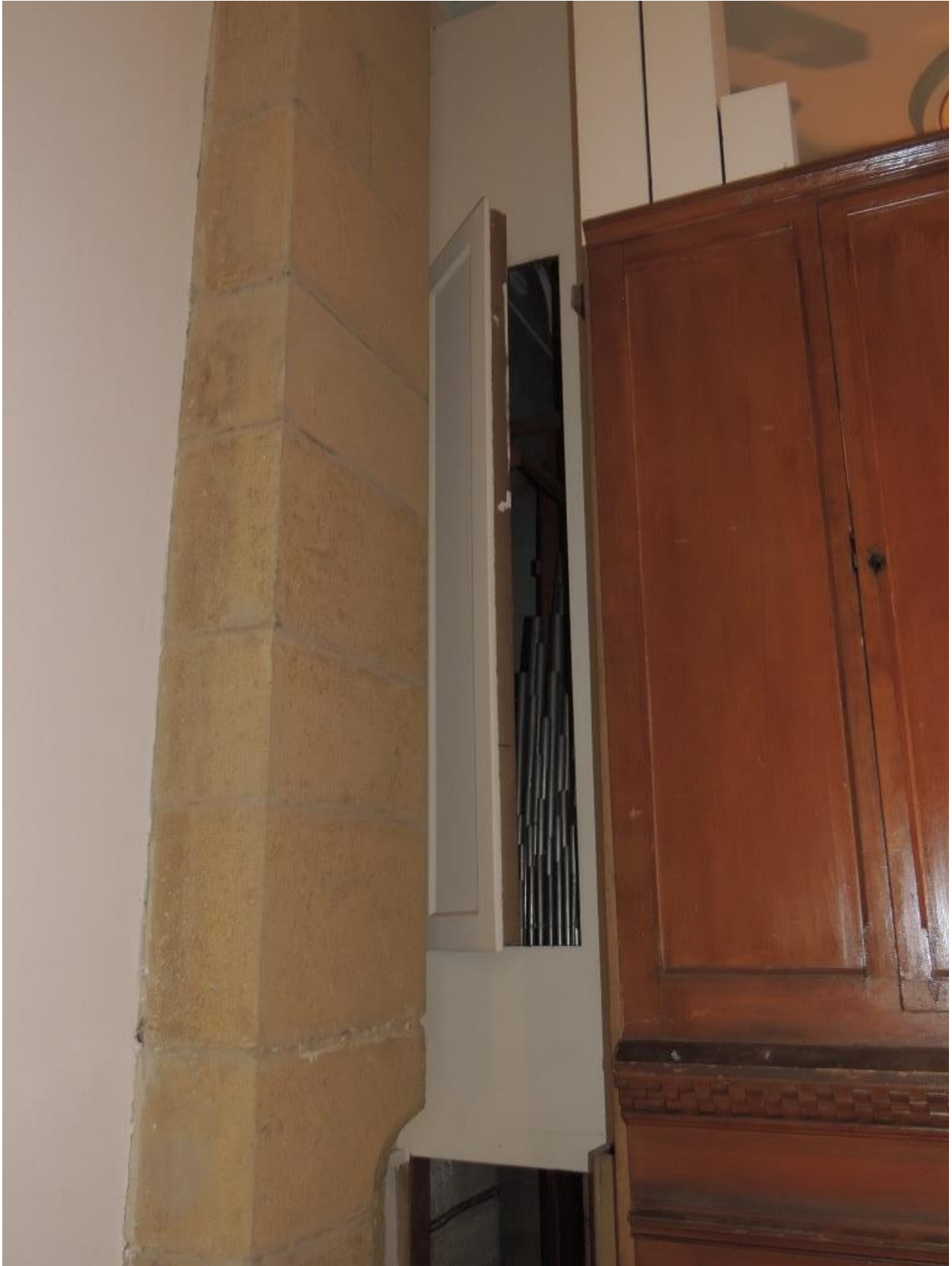
Abb. 59: Eine der beiden seitlichen Schwelltüren der Orgel von Jakob Zimmermann in Jettingen im Elsass (Bernhard Hörler).
