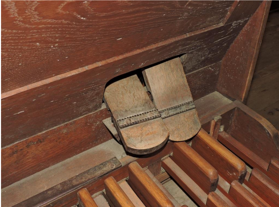
Abb. 146: Goldbach-Altenbach (Elsass), katholische Pfarrkirche St-Laurent, Balanciers für den Echokasten und das Registercrescendo im Spieltisch der Orgel von Jules Besserer von 1927 (Bernhard Hörler).
