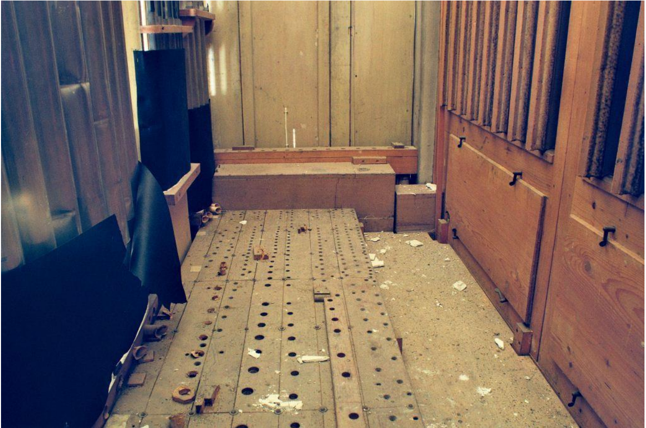
Abb. 376: St-Imier BE, christkatholische Kirche, das zerstörte Hauptwerk der Goll-Organ von 1912 – gut erkennbar sind die Reste der Verführungen zu den Prospektpfeifen (Bernhard Hörler).
